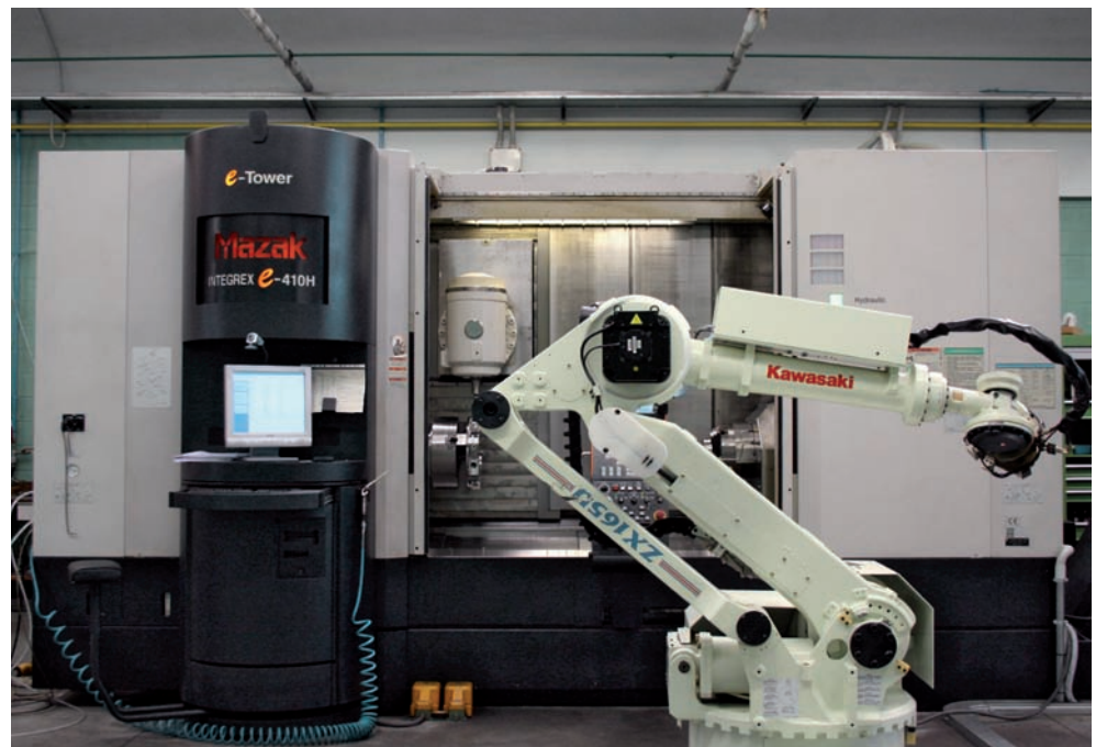
Centro di fresatura / tornitura MAZAK INTEGREX e - 410 H. Officina di Meda.
