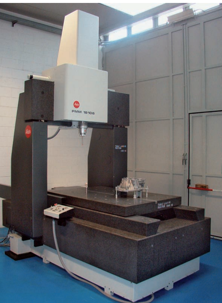
Macchina di misura Leitz PMM 18 10 6 ad altissima precisione.
